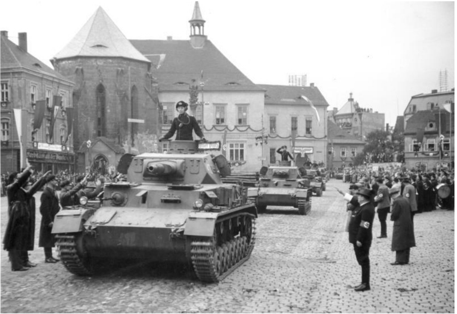
Panzer IV Ausf. A mit noch innenliegender Walzenblende und erkennbar vorgezogenem Fahrererker beim Einmarsch in das Sudetenland 1938
