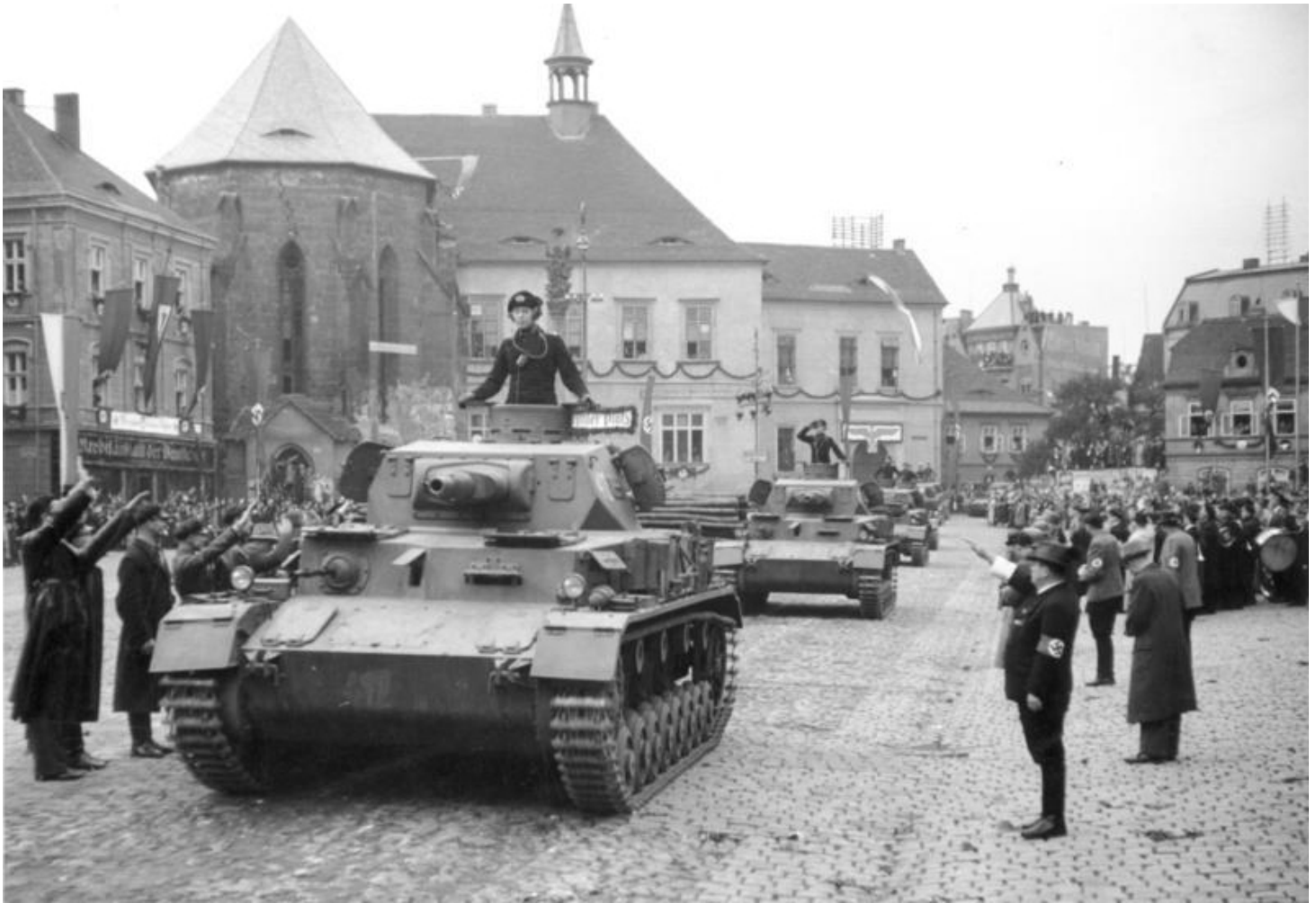
Panzer IV Ausf. A mit noch innenliegender Walzenblende und erkennbar vorgezogenem Fahrerkerker beim Einmarsch in das Sudetenland 1938
