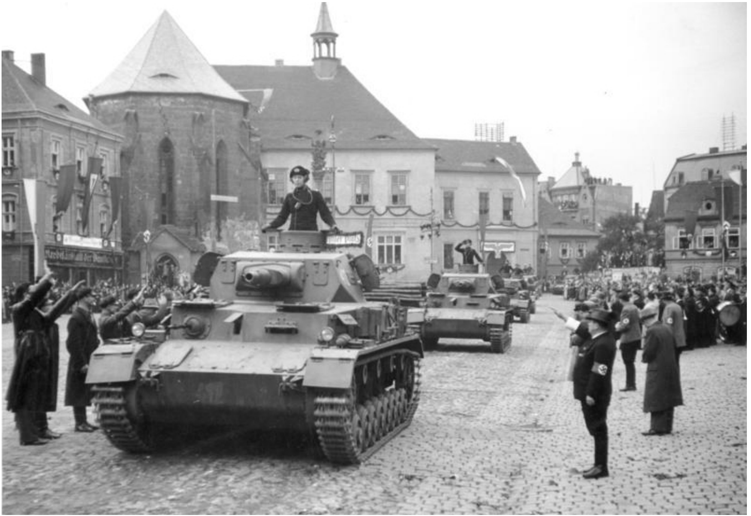
Panzer IV Ausf. A mit noch innenliegender Walzenblende und erkennbar vorgezogenem Fahrerkerker beim Einmarsch in das Sudetenland 1938
