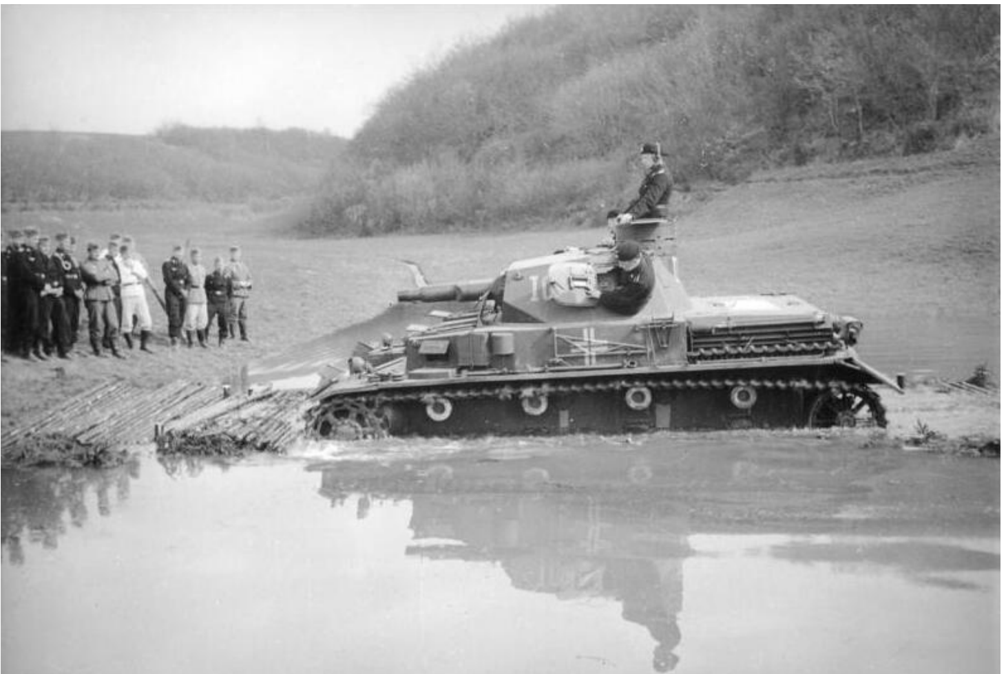
Panzer IV Ausf. A beim Durchfahren eines Gewässers- Übung / Vorführung [?] vor Wehrmachtsangehörigen u.a. der Panzertruppe am Ufer
